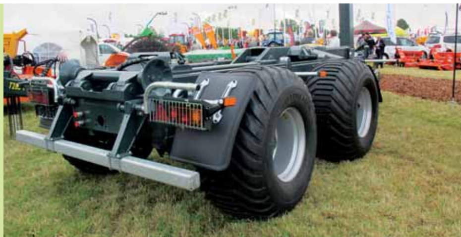
Traktortrukket kroghejsevogn med drejbar bogie - som på togvogne. Have & Landskab 2015.
