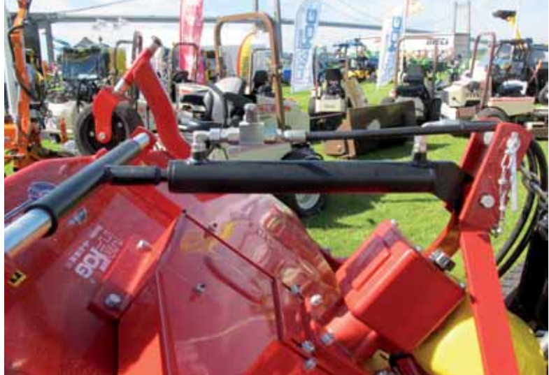
Med en flip up-cylinder kan klippeaggregatet hæves nemt og bekvemt.
