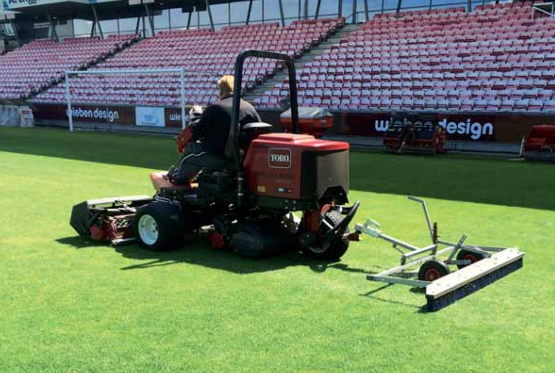
Simpel løsning med børstning. Optimalt set bør børsten sidde foran klipperen. Foto: Asbjørn Nyholt.
