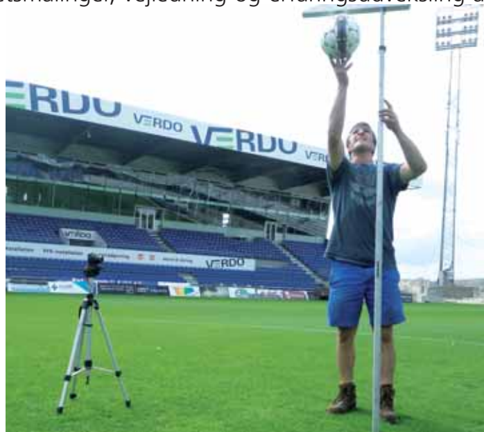
Måling af boldopspring. Er græsset langt og vækstlaget blødt, når opspringet ikke det optimale, 70-95 cm. Foto: Asbjørn Nyholt.
