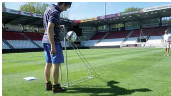
Måling af boldrul. Er græsset kort og overfladen for hård, løber bolden for langt. Rullet skal også være forudsigeligt. Foto: Asbjørn Nyholt.
