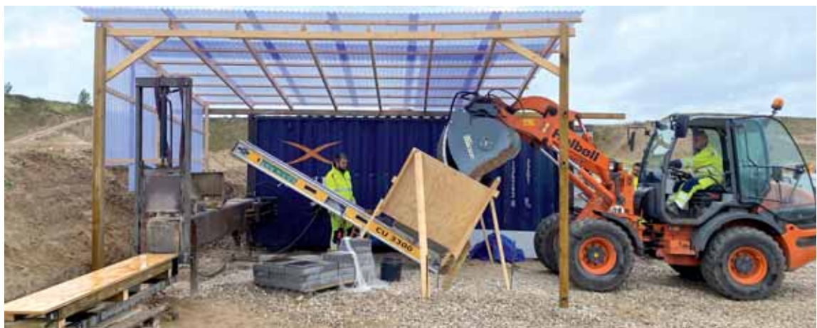
• Produktion af lerjordselementer i gang hos TSG. Her fyldes lerjorden op i en tragt. Derefter transporteres den via et transportbånd op i den ene ende af maskinen hvor den komprimeres. Foto: Niels Brix..
