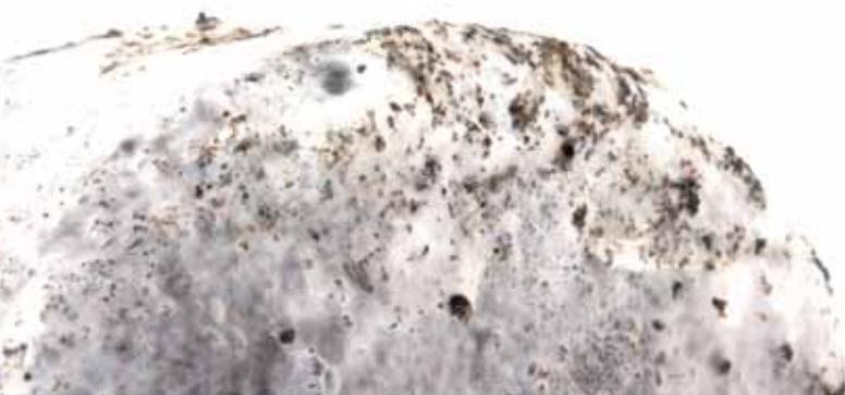
• Nærbillede af bindemidlet der forgrener sig om tilslaget. Foto: Visibuilt.
