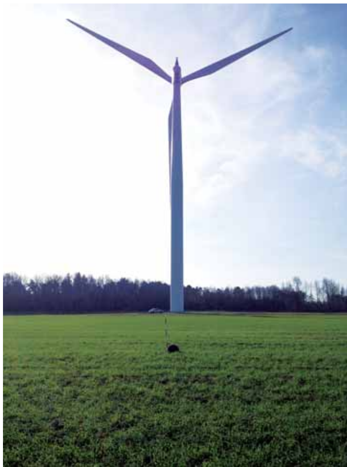
Sådan foregår en støjmåling i dag. Mikrofonen ligger under en vindhætte på en måleplade, én møllehøjde væk fra vindmøllen. Ud fra resultatet beregnes den almindelige støj udenfor naboens bolig og den lavfrekvente støj indeni naboens bolig. Nu skal den reelle lavfrekvente støj måles. Foto: Delta.
