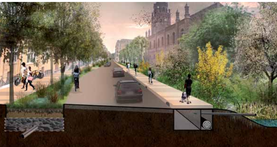
En grøn skybrudsvej kombinerer forsinkelse og begrønning. Her er Rambølls bud på at omdanne Matthæusgade på Vesterbro, øverst i tørvej, nederst ved skybrud. Visualiseringerne er udarbejdet til skybrudskonkretiseringsplanerne for København og Frederiksberg
