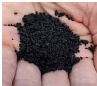
Biokul af slam fra forsøgsanlægget hos Vandcenter Syd. Foto: Vandcenter Syd.
