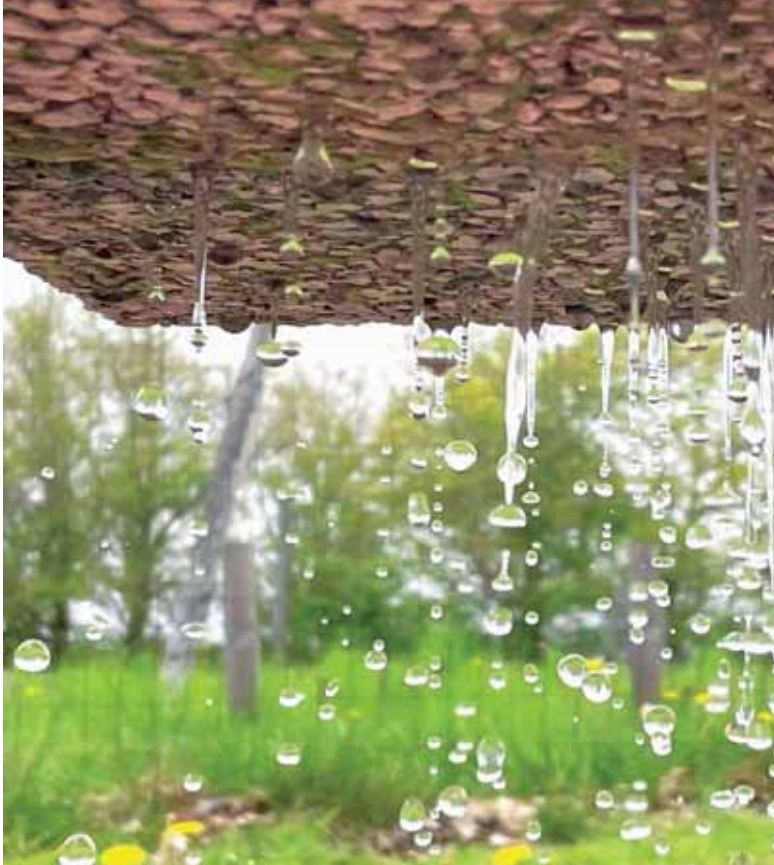
Anvisningens omslag viser hvordan vandet nærmest løber gennem et stykke permeabelt asfalt. Typisk er overfladelagets permeabilitet dog mindre end bærelagets og bliver derfor dimensionsgivende.
