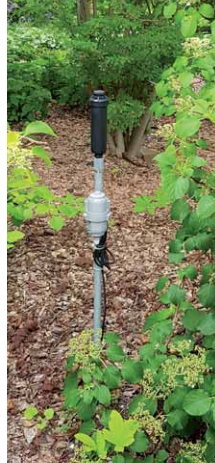
• Der vandes kun hvor der er behov. Jordens fugtighed måles af en underjordisk sensor. Senderen er den grå boks på vandingsstolpen. Foto: Anders Kristoffersson.
