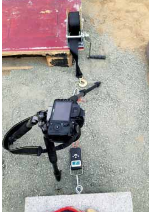
Med spil og fjedervægt måles den kraft der rykker stenen. Det dokumenteres med foto. Fra rapporten.
