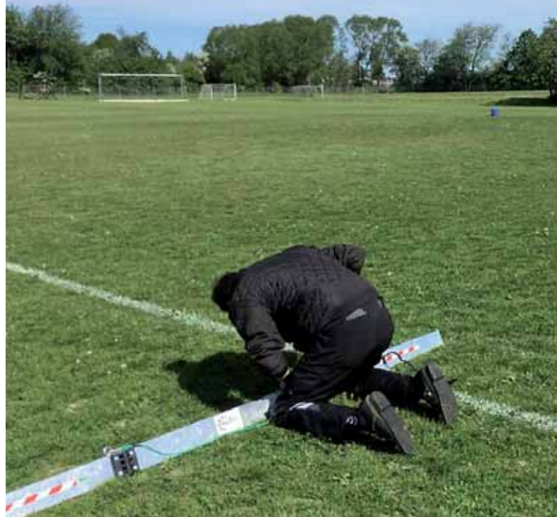
Målingen er i gang, her banens planhed som er den eneste spilletekniske måling der går igen fra elitebanetesten. Foto: Asbjørn Nyholt.
