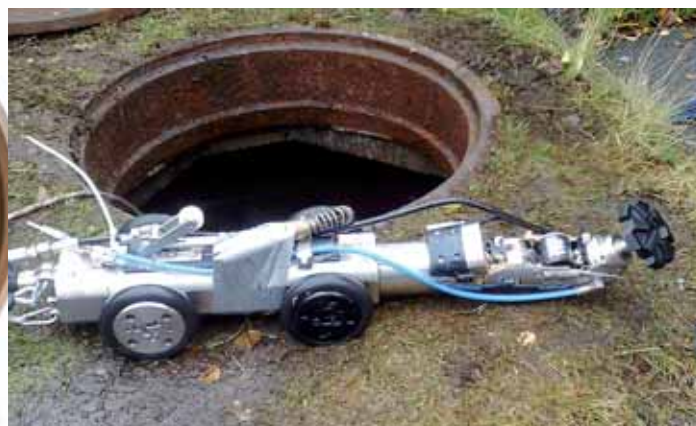
Denne robotfræser, Hydrocut 150, bruges til at fræse rødder bort, fjerne betonstykker mv. før foring og til at genåbne ledningen efter foring. Den kan bruges i rør på 150-800 mm. Foto: Kjell Wangberg Larsen AS.
