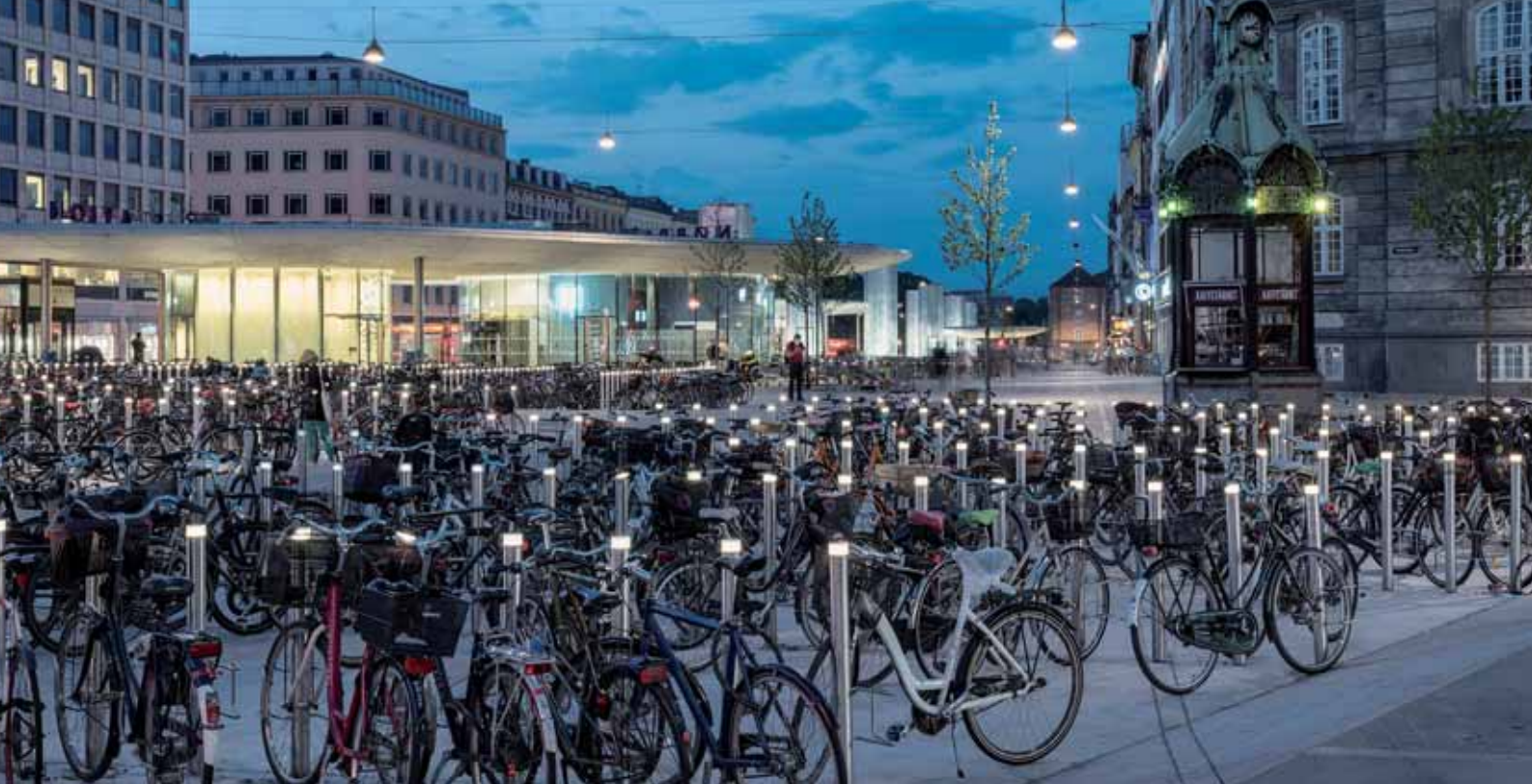
I cykelbedene uden tag er der et LED-armatur i toppen af hver stander. De får strøm fra indbyggede solceller med batteri. Foto: Jens Lindhe.
