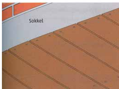
Når terrassebrædderne ligger parallelt med huset, kan strøerne monteres i bjælkesko direkte på facaden. Når brædderne er vinkelret på facaden, kan rammen gøres fast direkte til facaden. Træhåndbog 74.
