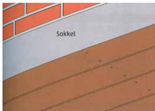
Når terrassebrædderne ligger parallelt med huset, kan strøerne monteres i bjælkesko direkte på facaden. Når brædderne er vinkelret på facaden, kan rammen gøres fast direkte til facaden. Træhåndbog 74.
