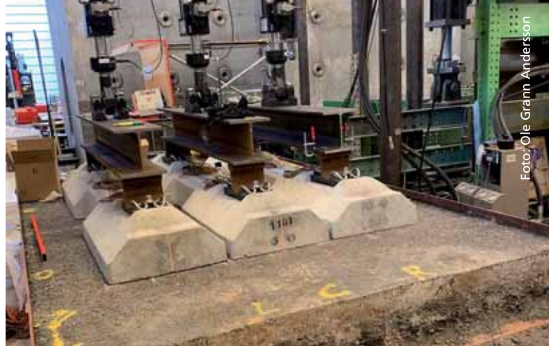
Mock-up af konstruktionen med asfalt udsættes for simuleret togtrafik.
