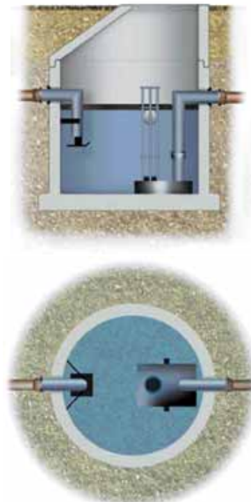
Unisep Olie- og benzinudskiller fra IBF til 'mindre oliemængder'. Den skal forsynes med automatisk flydelukke der lukker udløbet når olielageret er fyldt samt en alarm der advarer når det er ved at ske. Udskilleren er testet efter DS/EN 858-1. Udskillerne leveres med kapaciteter fra 3 til 50 liter pr. sekund og med integreret sandfang.
