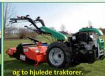
Stennedlægningsfræser til fire
