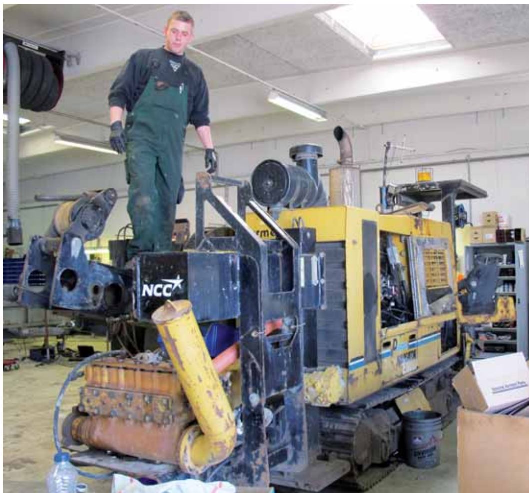
Maskiner til underboring har næsten erstattet kædegraverne. Her er en maskine til reparation.
