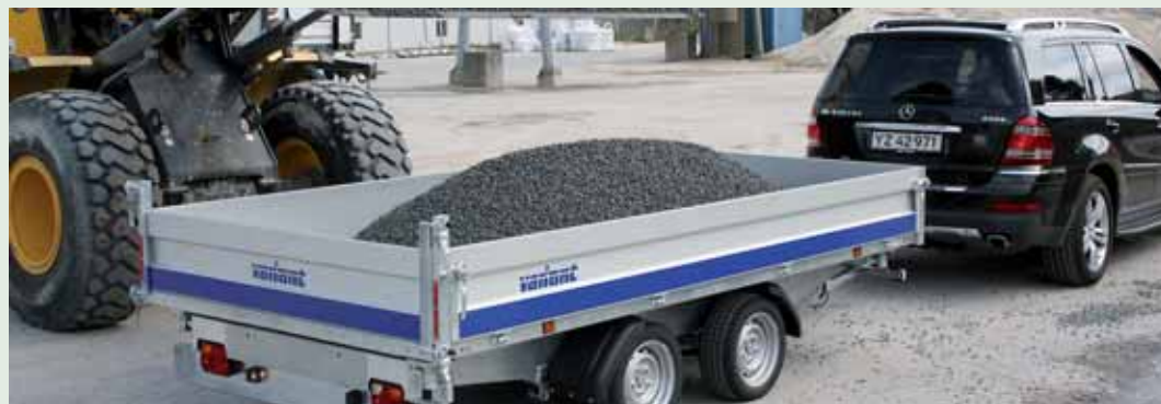
Alene egenvægten af denne Variant-trailer (1.100 kg) og Mercedes'en (2.585 kg) er over grænsen for hvornår man skal bruge fartskrivers. Totalvægten for hele ekvipagen er 6.750 kg. Foto: De Forenede Trailerfabrikker.
