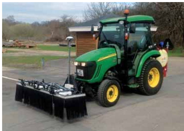
Slagelse Kommune sprøjter en del af sine belægninger for at spare. Det gøres med en helt ny maskine med WeedSeeker-teknolog. Kun ukrudtet sprøjtes, ikke belægningen som helhed. Foto: Slagelse Kommune.
