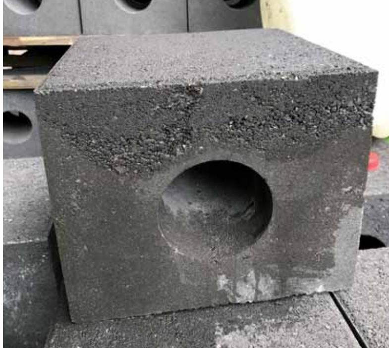
D: Rain er et betonelement med indbygget rund vandrende og en permeabel beton i toppen og vandet kan sive ind. Foto: Mikkel Priess.
