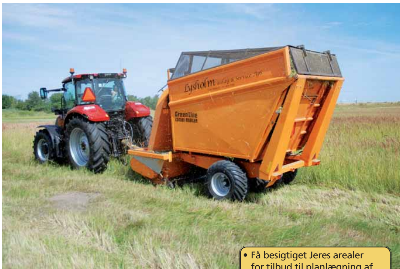
GreenLine Combi-trailer med 10 m 3 eller 17 m 3 opsamlervogn udstyret med ekstra hjulsæt til bløde arealer
