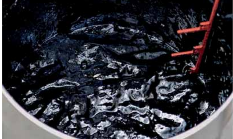
Bitumen skummet op med vand i en spand. På produktionsanlægget kan man ikke fotografere den lukkede proces. Foto: Teknologisk Institut.
