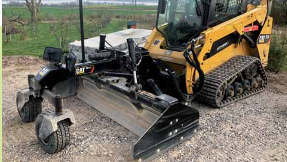
Graderen graderer jorden. Her er graderbladet sat på en minilæsser. Foto: Zeppelin Danmark.
