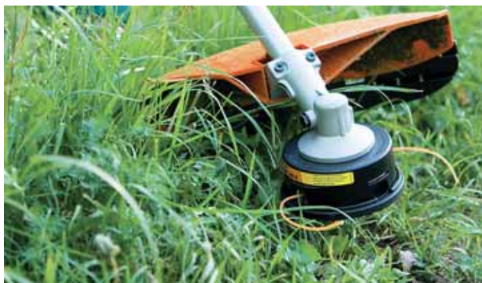
Trimmertråden skal passe til opgaven og trimmeren. Til allround brug er Stihls orange 2,4 mm tråd normalt et godt valg.
