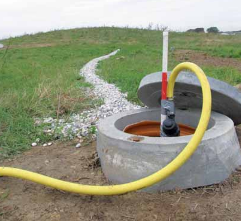
Infiltrationsrende i forsøgsområdet i Mårslet. Den lange og smalle form øger chancen for kontakt med højgennemtrængelige zoner i form af makroporer og sandlinser. Placeringen ved overfladen udnytter at topjorden kan aftage mest vand. Desuden er det nemt at holde øje med anlægget. Foto: Marina Bergen Jensen.
