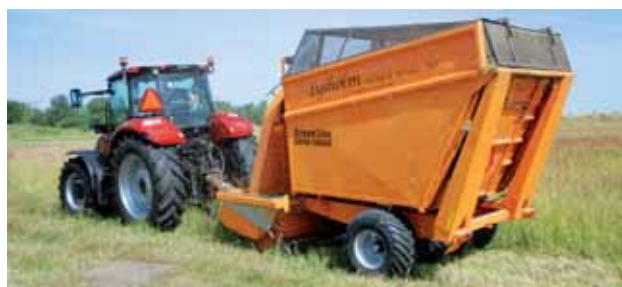
GreenLine Combi-trailer med 10 m³ opsamlersudstyret med ekstra hjulsæt til bløde arealer
