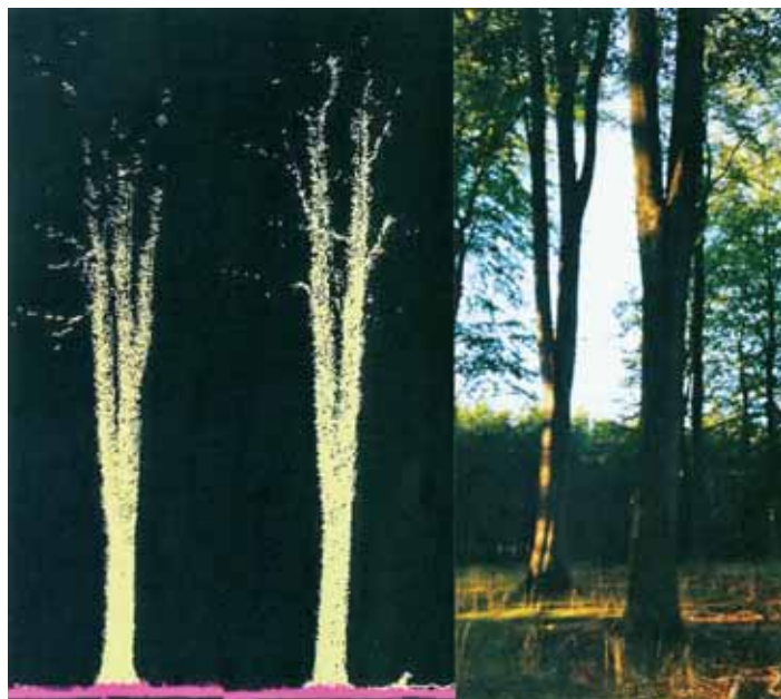
Laserscanning af bøge. Man kan få præcise 3d-billeder af hele stammen.
