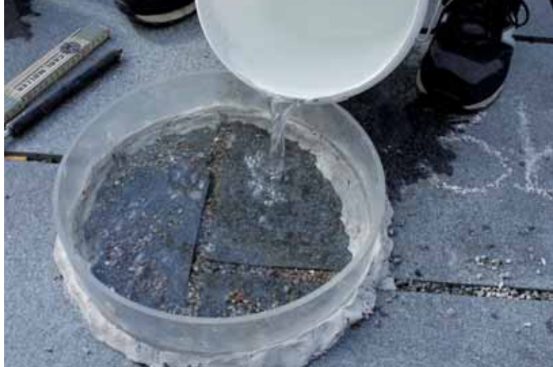
3,6 liter vandet hældes ned i infiltrationsringen der er kittet godt fast til belægningen. Foto: Jan Støvring.
