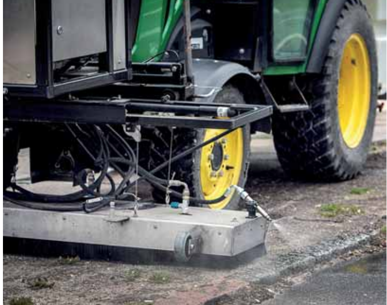
Det hede vandt sprøjtes ud af dyser i dysebommen. En skråtstillet dyse tager ukrudtet der vokser lige uden for bommen. Foto: OKNygaard.
