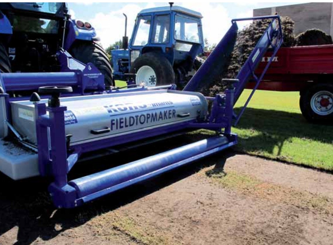
Topskærermaskinen i aktion. Det afskrællede top lag transporteres over i en vogn ved siden af.
