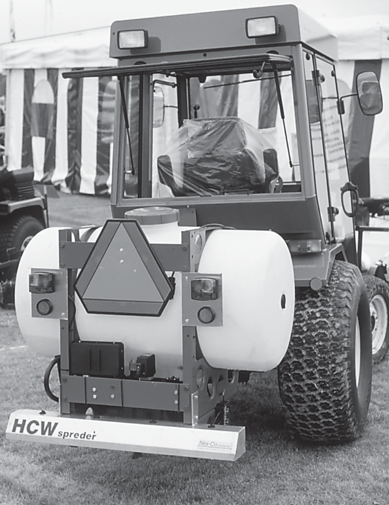
Saltvandsspreder blev præsenteret som en nyhed på Have & Landskab i 1997. Perspektivet var stort - og er det stadig. I dag kan man konstatere at teknikken kun har fået større praktisk betydning på større veje.
