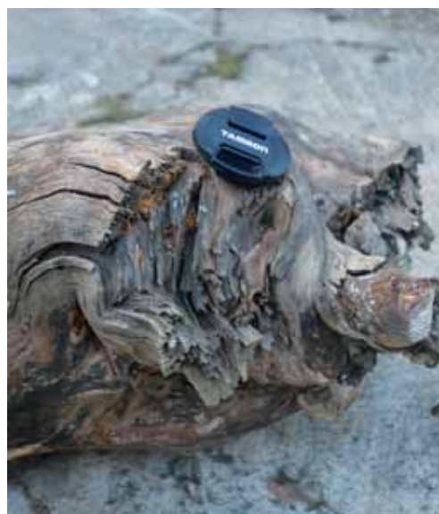
Fig. 6. Den eneste større horisontale rod havde kraftige forstyrrelser af fiberforløbet i overgangen mellem stamme og rod.
