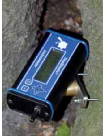
Rodbevægelsesmåleren (inklino-metret) sættes på rødder eller rod-anløb med to skruer og nulstilles.
