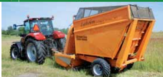
GreenLine Combi-trailer med 10 m³ opsamler udstyret med ekstra hjulsæt til bløde arealer
