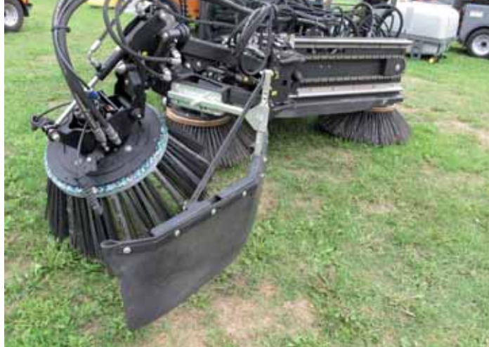
Kärcher har koblet en ukrudtsbørste til fejmaskinen.
