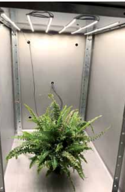
Nyrebregne, Nephrolepis exaltata , i plantemålekammeret med sensorerne bag planten og LED-lys i toppen for at simulere indeklima. Foto: Katrine Heinsvig Kjær.
