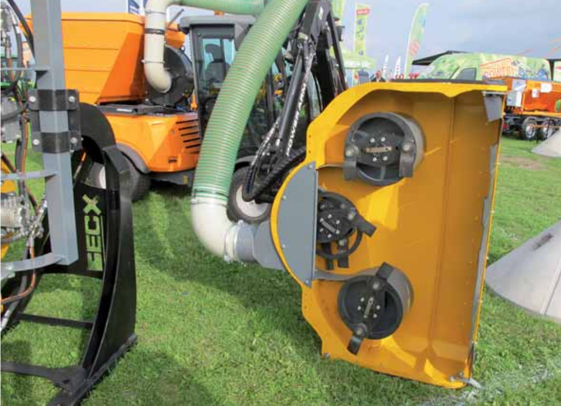
GMR's Becq-hækkklipperens afklip sendes via slangen til findeling - og derfra til beholder eller uddrysning.
