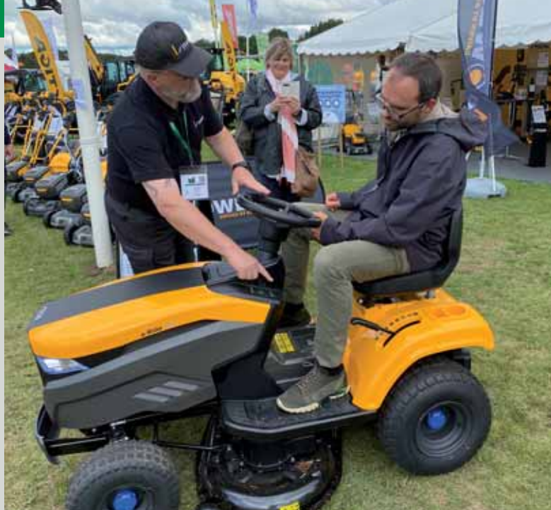
Karsten Hageform får anvist hvordan den eldrevne Stiga-traktor kun kan bakke når knappen holdes inde. Foto: Bente Mortensen.
