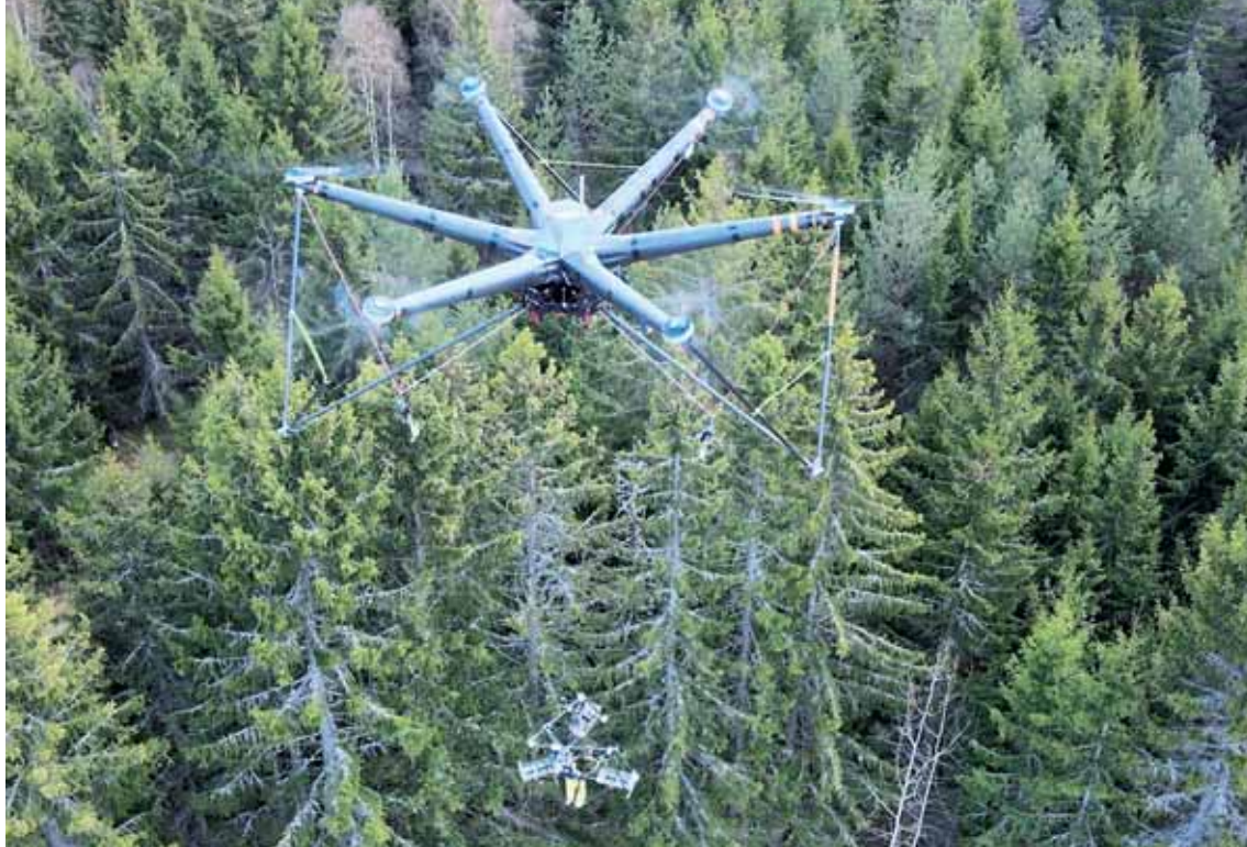
• Dronen nedsænker et processorhovede der afgrener, fældes og løfter træet op. Foto: Airforestry.
