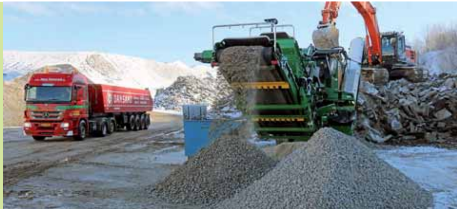
Knust beton i vej anlæg: genanvendelse eller bare nyttiggørelse af affald?
