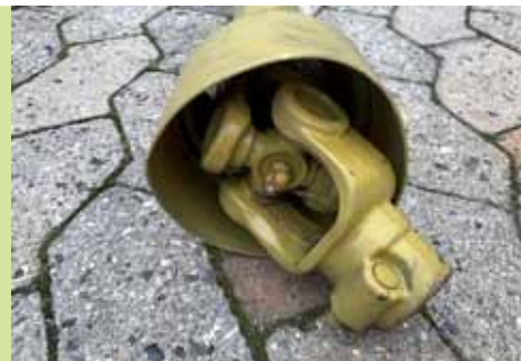
En PTO og kraftoverføringsaksel med afskærmning. Fotos: Wikipedia og Klaravik.
