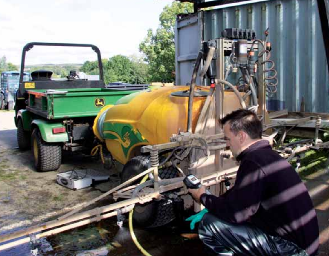
Hver enkelt dyse skal testes for at vurdere om de er slidt, og eventuelt skal skiftes. Dyserne testes med en flowmåler, det er præcist og rimelig hurtigt gjort.
