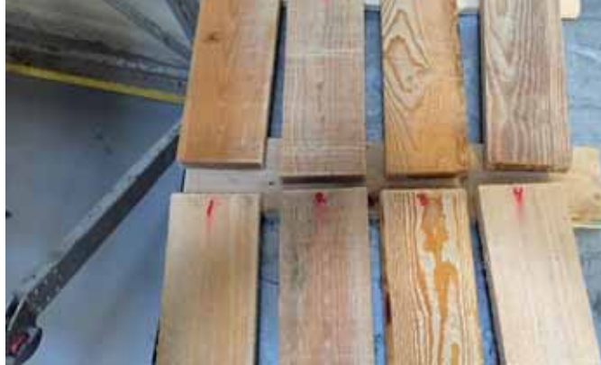
Træmner lagt til tørring efter imprægnering. Foto fra rapporten.
