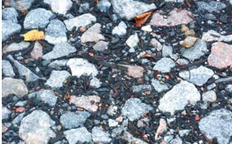
Figur 6. Komprimeret granit-makadam med biokul.
