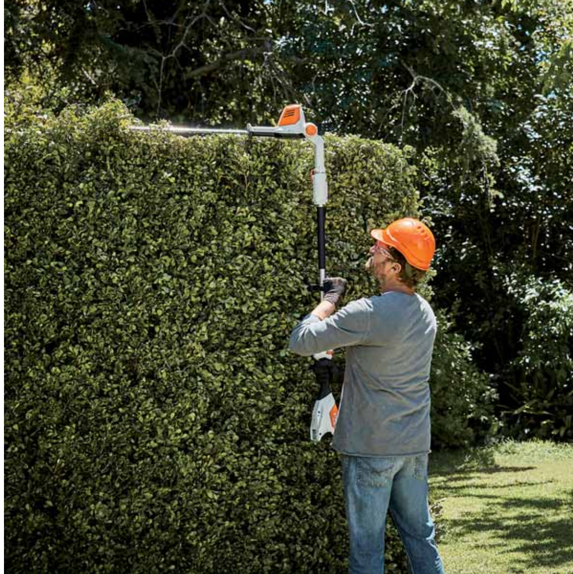
Når stangklipperen har et justerbart klippehoved, kan man stå på jorden og tage den høje hæks top. Foto: Stihl.
