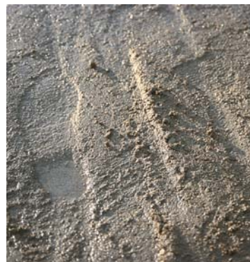
For mindre anlæg accepteres at komprimeringskontrollen baseres på erfaringer for maskinstørrelse, antal passager m.v. suppleret med enkle tests baseret på aftryk fra komprimeringsgrej, hjul m.v. i overfladen. Foto: Torben Dam.
