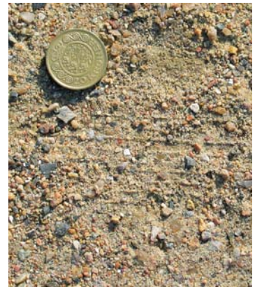
Leret grus 0-8 mm med mange skarpe korn.
