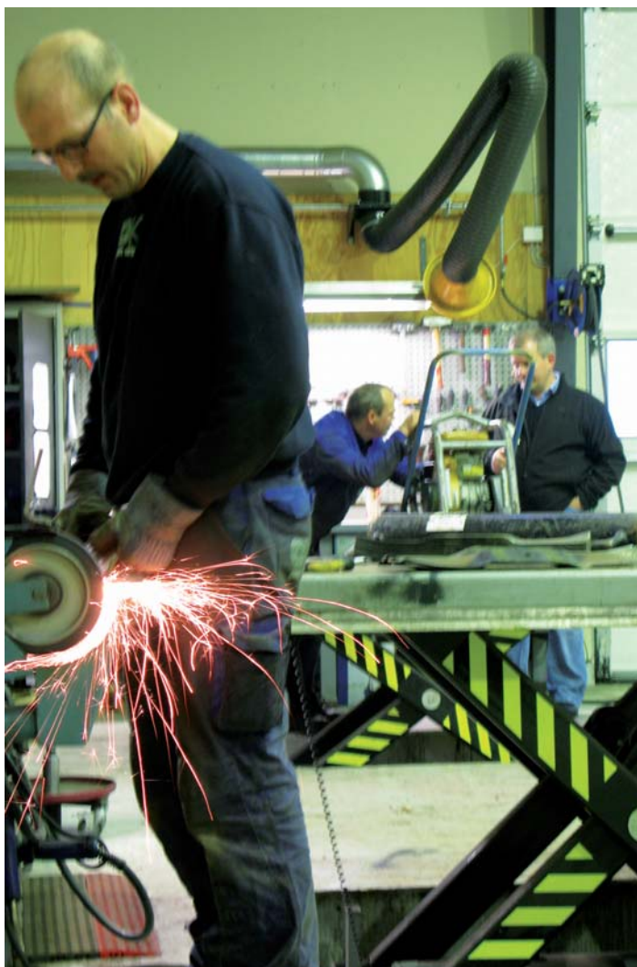
Steen Jensen er en af OK grøn anlægssmede og er her i færd med at slibe rotorbladene på de mange klippere. I baggrunden får Ole en snak med lederen for værkstedet, smed Lars Petersen der er i færd med at bakke med en pladevibrator.
