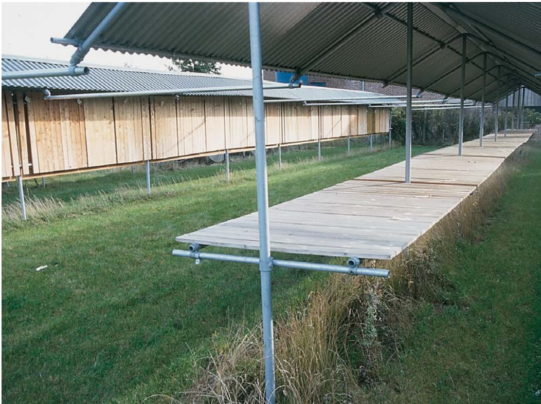
På Teknologisk Institut Træteknik afprøves i et igangværende forsøg cirka 20 almindelige danske træarters bestandighed over for vejrligets påvirkning. Afprøvningen er rettet mod træ uden jordkontakt. Forsøgsopstillingen eksponerer træet lodret, vandret og skråt i 45 grader, både overdækket og frit eksponeret mod henholdsvis syd og nord. (Foto: Torben Dam)
