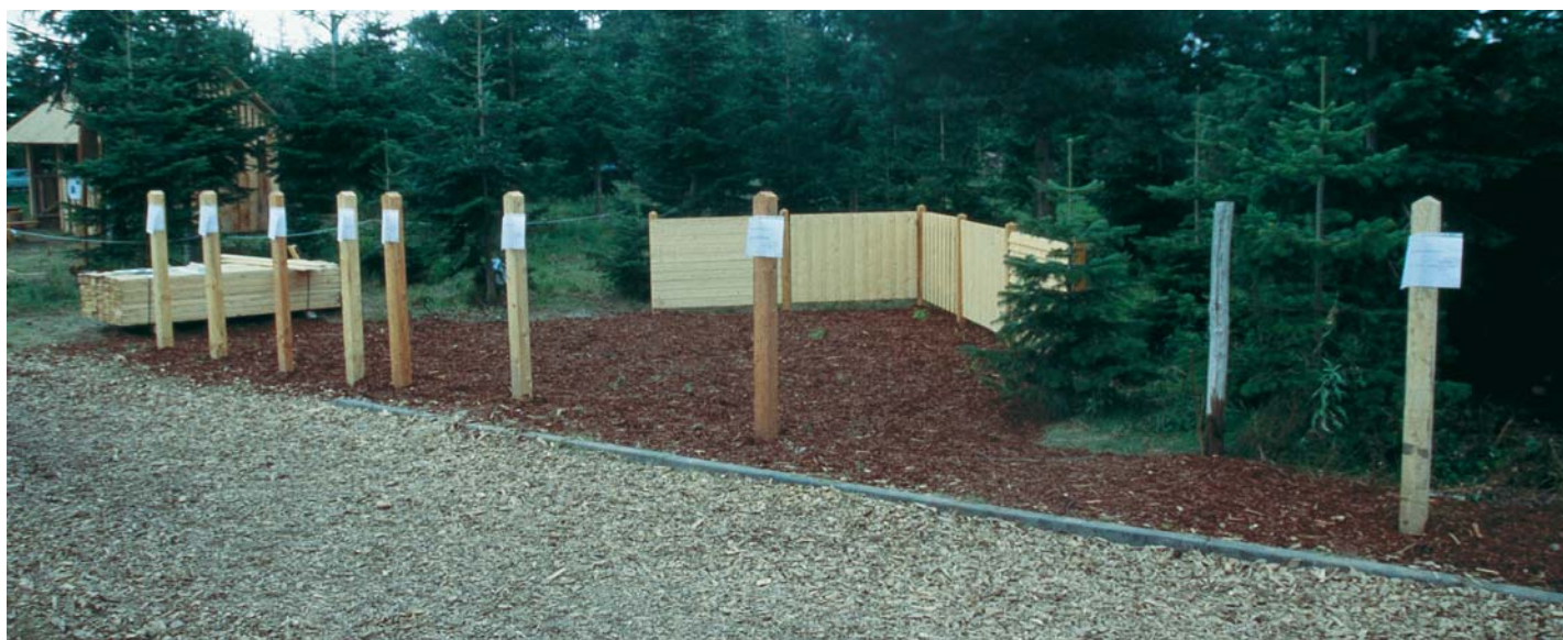
Stolper af forskellige træarter er sat med en afstand der svarer til deres varighed i kontakt med jord. Det er robinie længst til højre. Fra udstillingen Have & Landskab '99. (Foto: Torben Dam)
