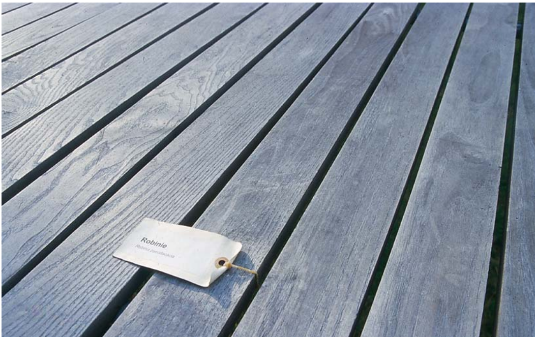
Fra samme afprøvning hvor der er gået tæt på en beklædning af robinie. Alt ubehandlet træ får efter en sæson en silkegrå overflade. Der er derfor ikke megen idé i at vælge træart efter den farve den har i frisk tilstand. (Foto: Torben Dam)
