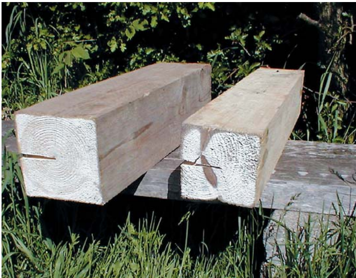
Bjælkens svind er koncentreret i savsporet (kærven) hvorved dannelsen af tørreridser og -revner reduceres til et minimum. Styringen af svind sikres gennem endeflædeforsegling, her med vandfast PVA-lim. (Foto: Claus Buhl Sørensen)
