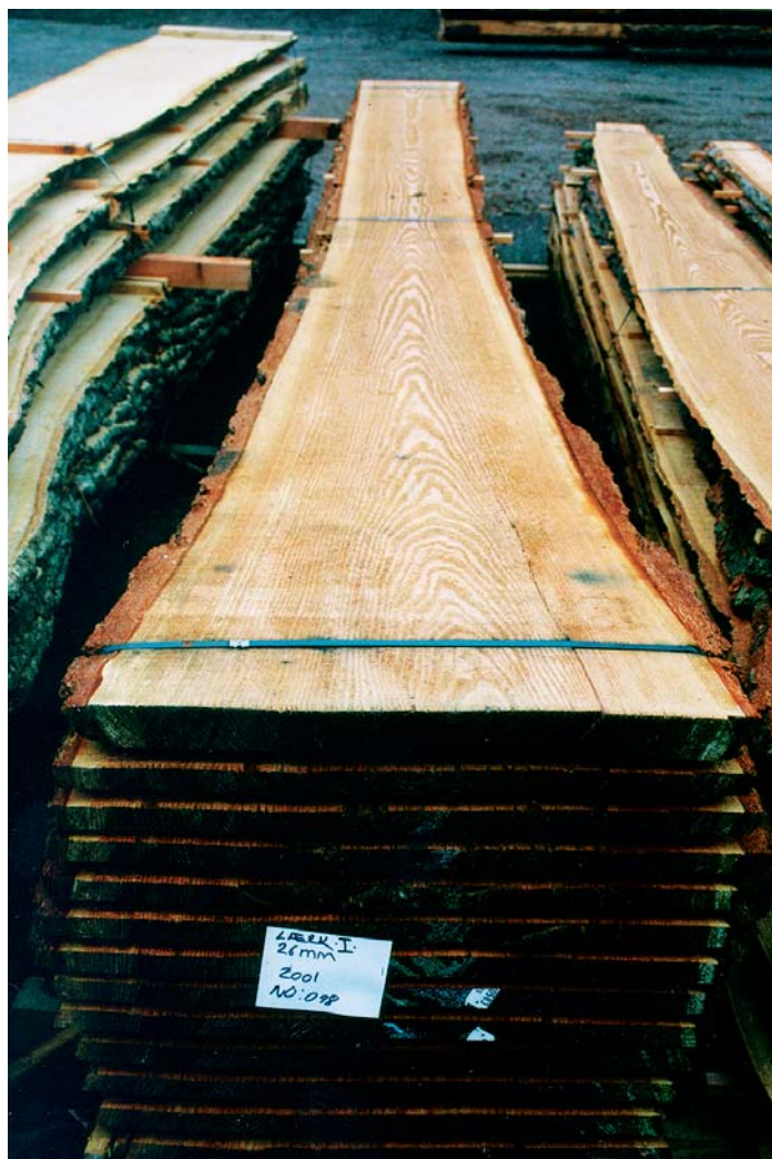
Lærken her er blevet stresset af vindpåvirkning fra højre og har dannet ekstra tykke årringe på læsiden som modtryk (trykved). Dette kombineret med snoet vækst giver kraftige vækstspændinger i træet, hvilket forklarer de stramme metalbånd. Læg i øvrigt mærke til den store kerneandel. (Foto: Dorte Klarskov Petersen)
