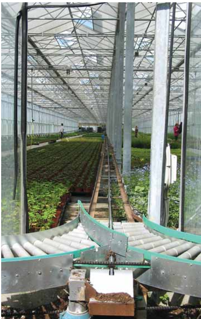
Selv gjort er velgjort, og så kan man selv reparere det så man ikke skal vente på montører udefra. Derfor er transportbåndet der sender planter fra væksthuset til containerpladsen, bevidst holdt enkelt og robust.
