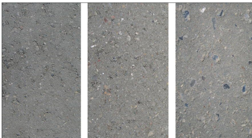
Ved afsyring af sten fjernes lidt af cementpastaen, så tilslaget bliver mere synligt, svarende til det slid der kommer i løbet af ca. ét år. Til venstre ses en ny sten, i midten en afsyret sten og til højre en ca. 1 år gammel sten.
