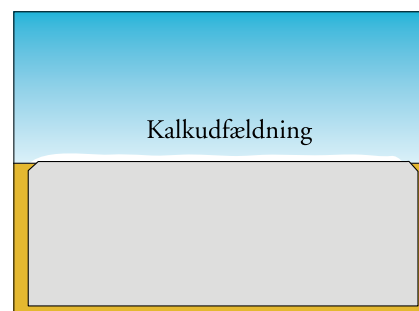
Vandet fordampes og kalkudfældningen dannes. Kalkudfældningen kan også ske under overfladen af stenen og er i så fald ikke synlig.
