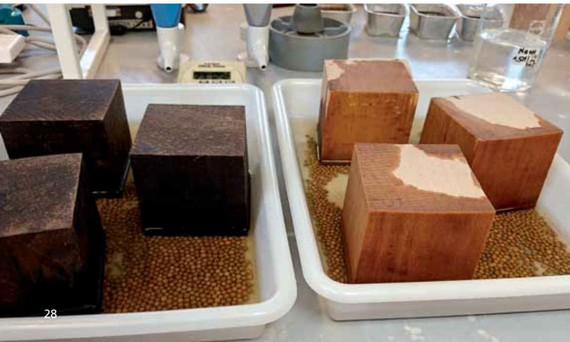
• Test af vandoptag i hyperlignificerede træklodser (til venstre) og ubehandlede træklodser (til højre) begge bøg. Fugtoptaget falder betydeligt i det hyperlignificerede træ. Foto: Sune Tjalfe Thomsen.
